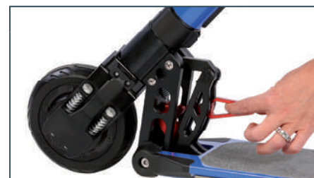
Vouwmechanisme – hand- of voetbediening mogelijk
