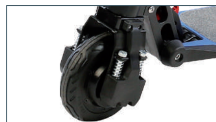
Geveerde voorvork met massieve rubberband en naafmotor
